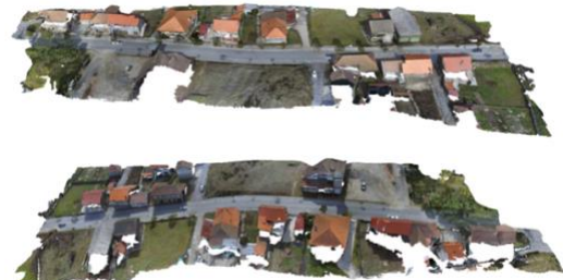
Figura 5. Reconstrução texturizada vista de dois lados opostos, usando o método SIFT no dataset nº1
