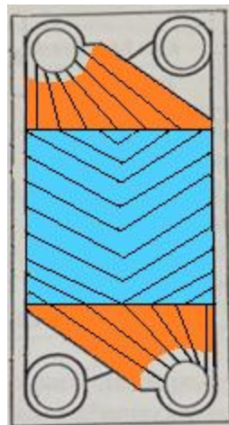
Figura 3.9 – Diferentes áreas de uma placa de transferência de calor.
