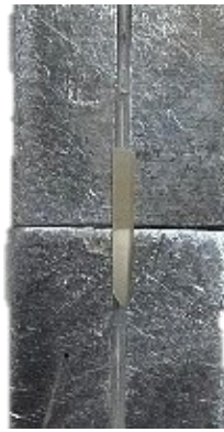
Figura 8- Palito fixado a jig de Geraldeli para teste na máquina de testes universal
