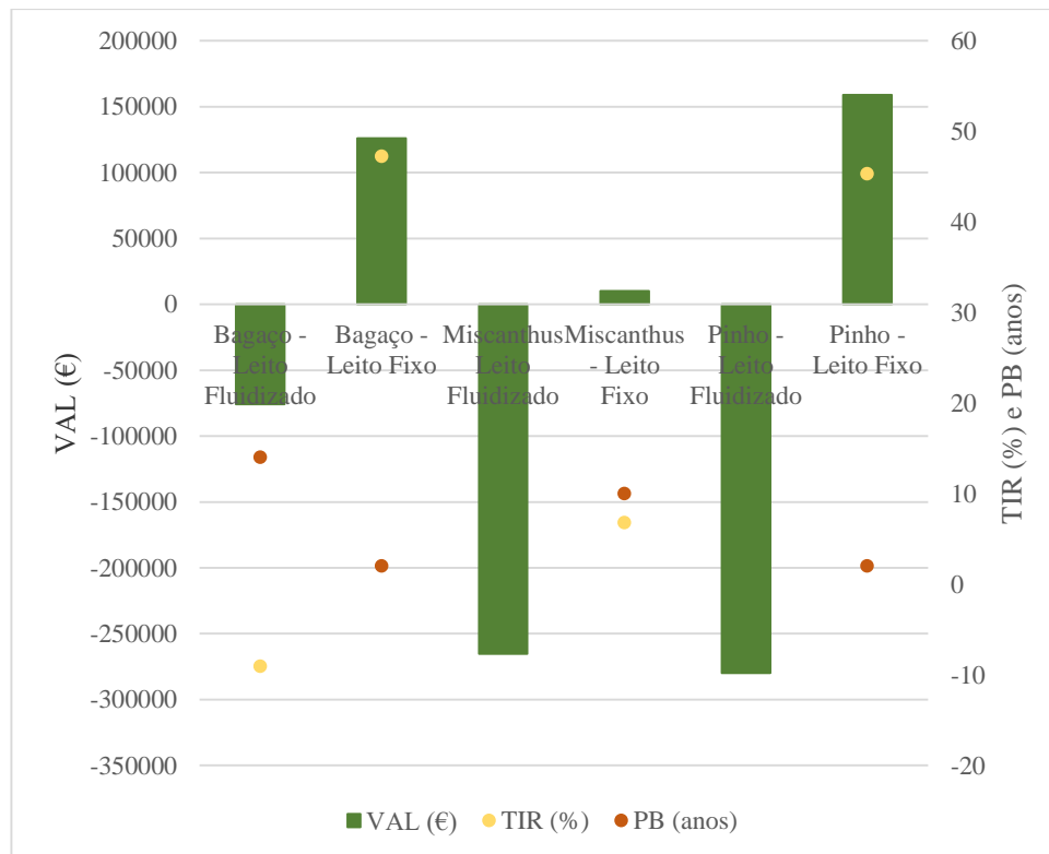
Figura 34 : Comparação entre fluxos atualizados dos processos de gaseificação e três matérias-primas diferentes.
