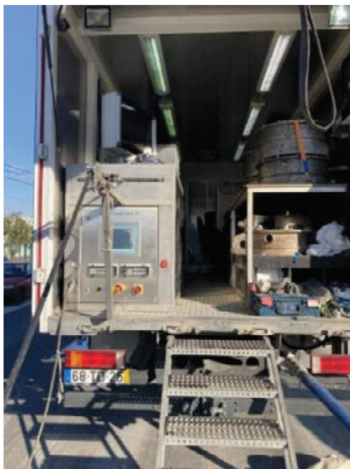
Foto n.º 20 - Camião de controlo equipado para a cura do da manga (Perfurações Dirigidas do Centro, 2020)
