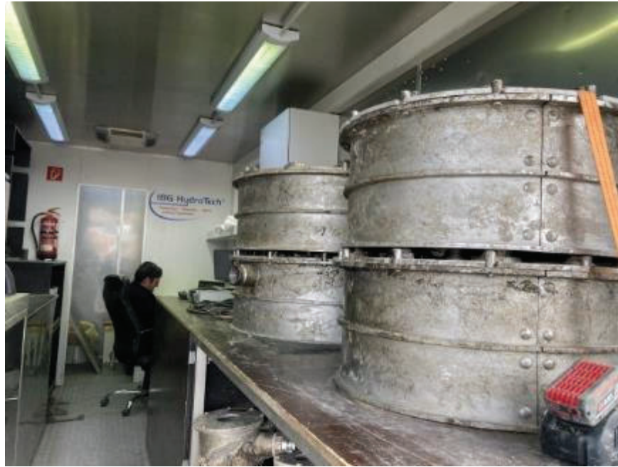
Foto n.º 22 - Tampas metálicas para colocar nas extremidades da manga de forma a permitir o insuflamento (Perfurações Dirigidas do Centro, 2020)
