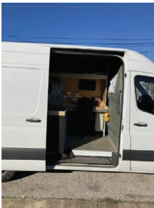
Foto n.º 19 - Carrinha de inspeção vídeo (CCTV) (Perfurações Dirigidas do Centro, 2020)
