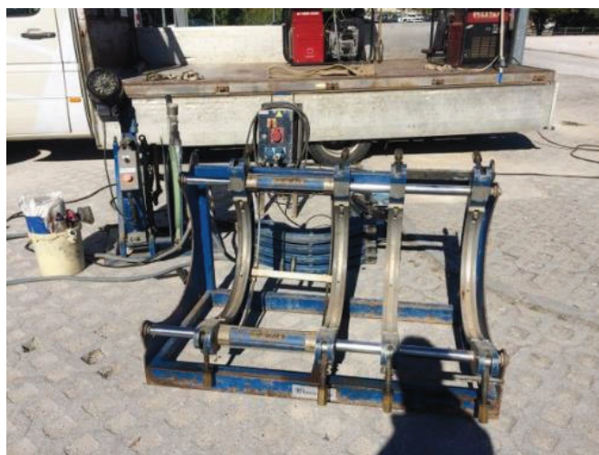
Foto n.º 45 - Máquina de soldadura de PEAD topo a topo por Termo fusão
