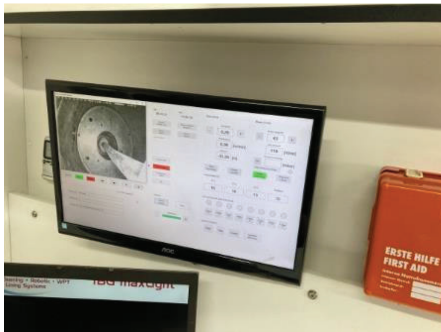
Foto n.º 23 - Ecrã de controle dos parâmetros de cura (Perfurações Dirigidas do Centro, 2020)
