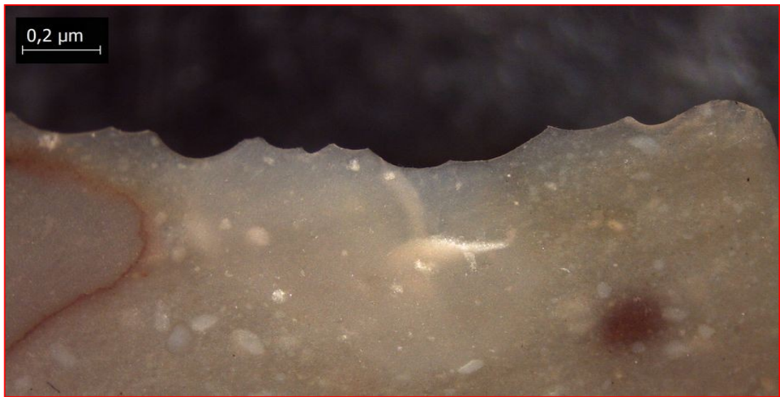
Figura 28. S10, ingrandimento 30x: ampie sbrecciature a forma di mezzaluna, molto profonde e continue.
