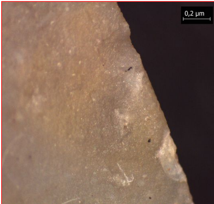
Figura 15. S11, ingrandimento 30x: piccole sbrecciature continue e poco profonde
