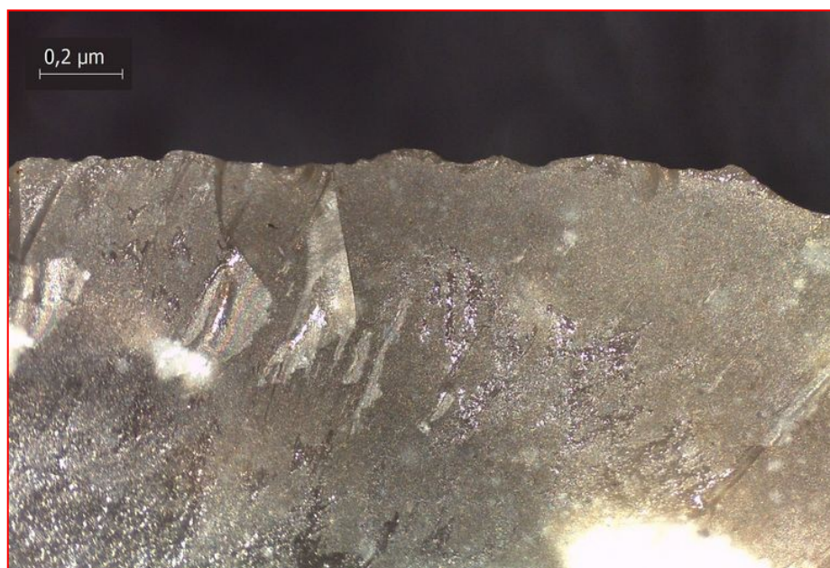
Figura 20. S13, ingrandimento 20x: piccole e profonde sbrecciature continue a forma di mezzaluna.
