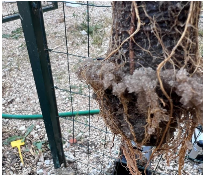
Figura 5 - Polyter presente no final do ensaio onde é possível ver a água retida
