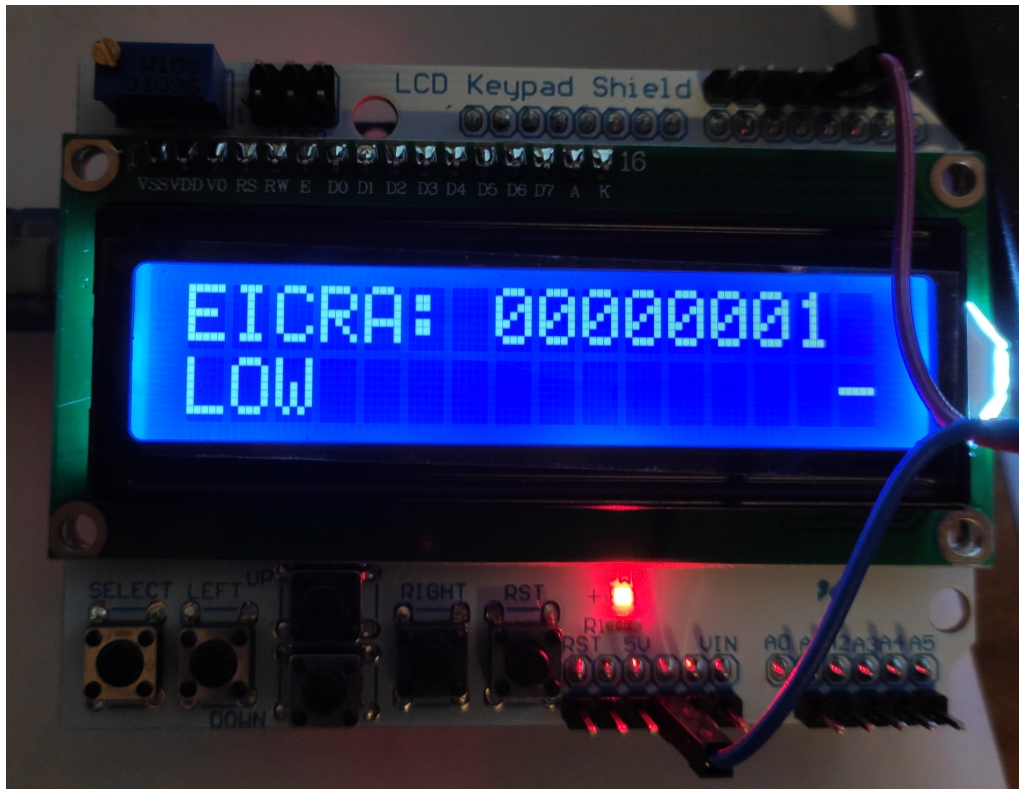
Figura 6.2: Valor do registo EICRA num LCD
