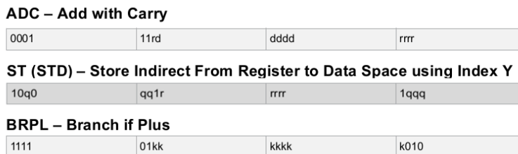
Figura 4.8: Formato das instruções AVR Adaptado de Atmel, 2018
