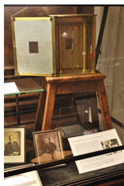
Figura 3.11: Aparelho piezoelétrico desenvolvido pelos irmãos Curie (Historical Medical Library, 2021).
