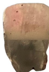
Figura 34 – Espécime a seguir a imersão na solução fotográfica reveladora e do verniz das unhas ter sido raspado.
