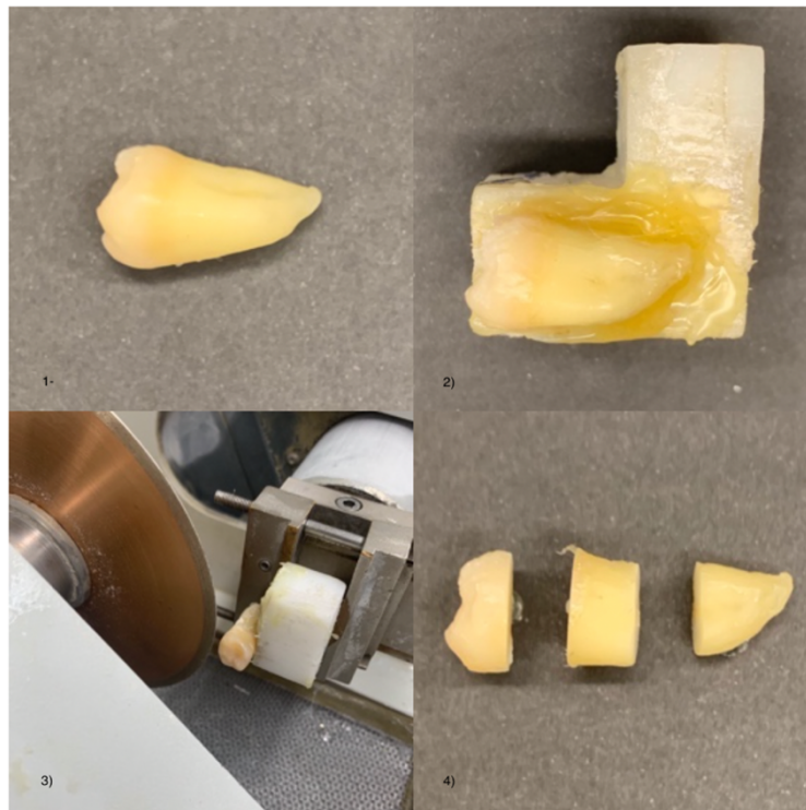
Figura 21 - Sequência de corte da amostra (1- Dente hígido; 2 – Dente montado num-porta amostras com cera colante; 3 – Porta amostras montado no micrótomo de tecidos duros; 4 – Dente depois de ser submetido aos 2 cortes paralelos à face oclusal).
