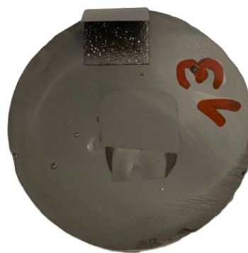
Figura 45 - Amostra revestida numa liga de ouro-paládio de 12nm de espessura.
