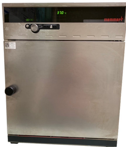
Figura 28 - Estufa de incubação (Mettmert INE 400, Mettmert, Germany).
