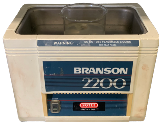
Figura 43 – Espécimes no banho de etanol no ultrassom (Branson Ultrasonic, Emerson Electric, Connecticut, USA).
