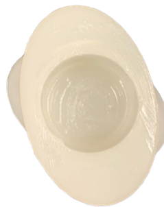
Figura 38 - Cilindros (FixiForm, Struers, Denmark) vaselinados.
