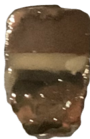
Figura 32 – Espécime após 24 horas imerso na solução de nitrato de prata amoniacal a 50% (pH 9,5).
