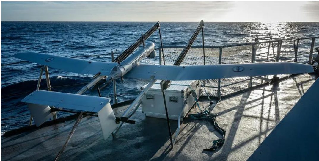
Figura 8 - Drone Aliaca fixado a uma catapulta de lançamento [Fonte: Airbus]
