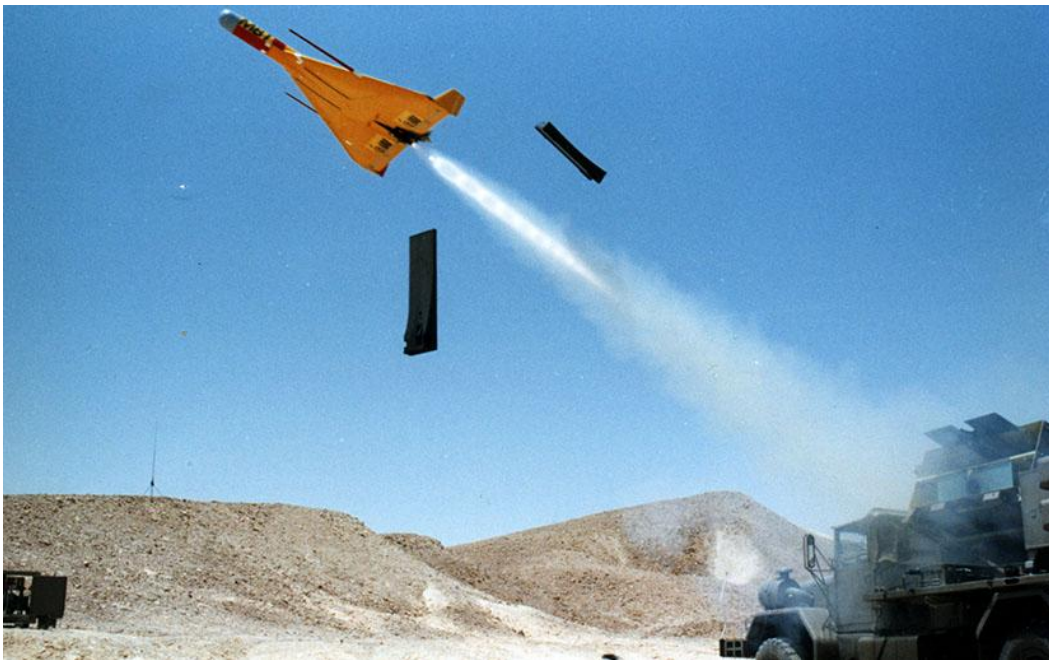
Figura 14 - Harpy a ser lançado de um sistema móvel [Fonte: Israel Aerospace Industries]
