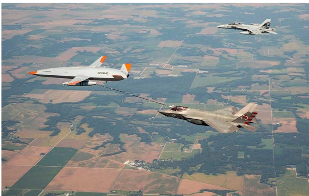
Figura 4 - MQ-25 Stingray em operações de reabastecimento com um F-35C [Fonte: Boeing]
