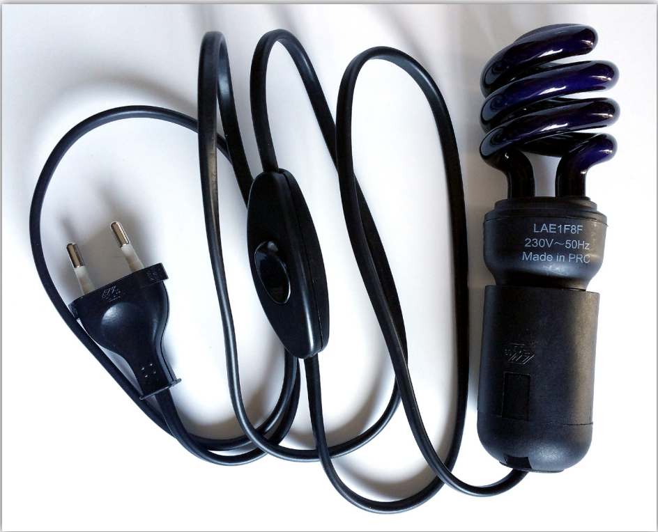
Lâmpada de “luz negra” UV e gambiarra construída, para montar na “mini câmara escura” (fotos do autor)
