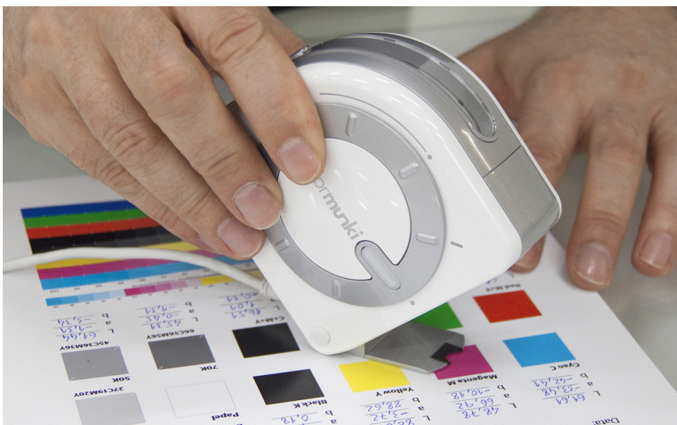
Fotografia 1: Espectrofotómetro ColorMunki posicionado para medir uma amostra. (do autor)
