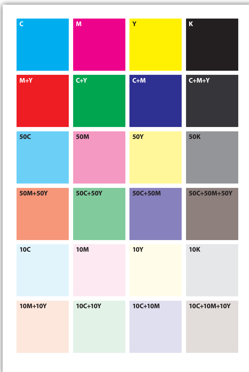
Figura 10: O teste de impressão criado e usado, com as cores primárias e secundárias da síntese subtrativa CMYK, compostas com 100%, 50% e 10%. (do autor)
