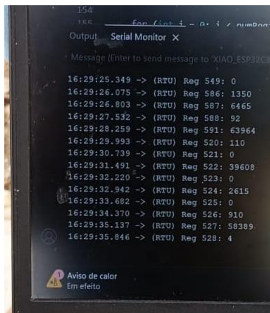
Figura 39 - Fotografia de alguns resultados da leitura de dados via Modbus RTU em ambiente real.
