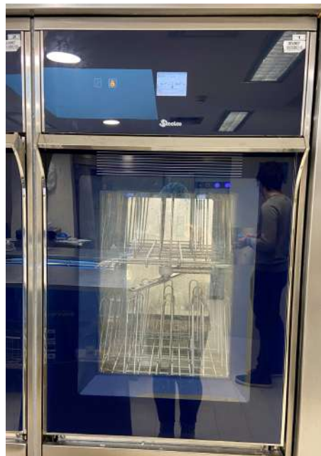
Figura 3.29: Equipamento de lavagem e desinfeção Steelco modelo DS-500.
