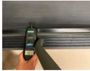
(a) Medição da velocidade da passadeira - utilização do equipamento de teste DT-2236C
