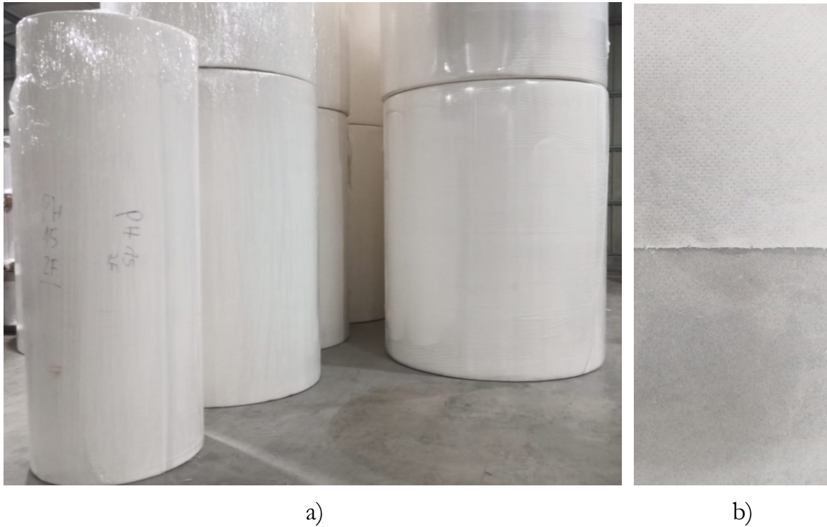
Figura 3.1 - A figura apresenta a dimensão das bobines e os tipos de papel utilizados no fabrico de produtos de higiene: a) Bobines de Matéria b) Papel "pasta" acima e Papel "sulfito" abaixo
