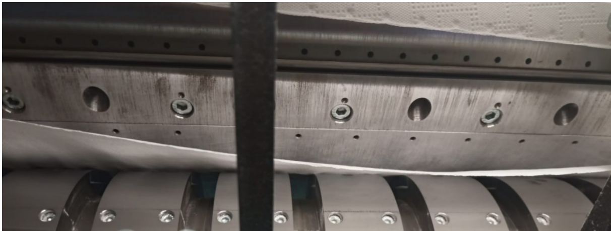
Figura 3.9 - Rolo superior responsável pelo corte e Rolo inferior responsável pela dobra
