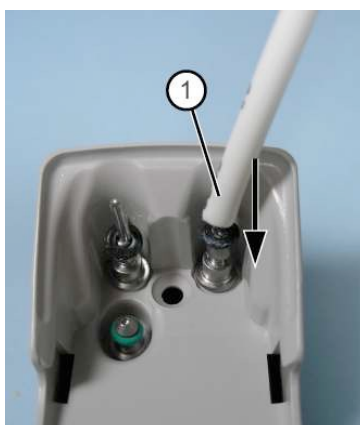
Figura 108 – Vista interior do copo de condensados (V).
