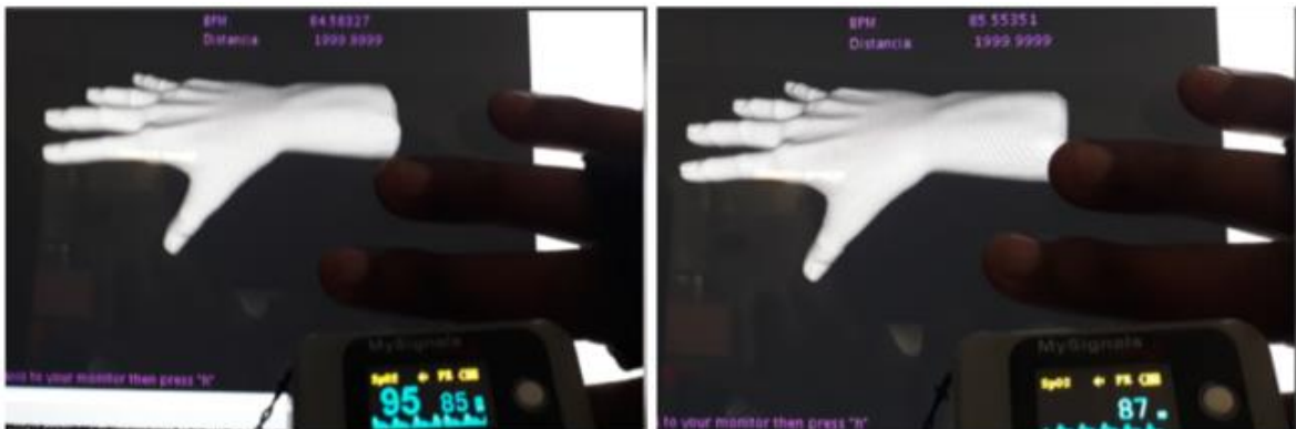
Figura 58 - Testes do sensor MAX30105 em contexto experimental.
