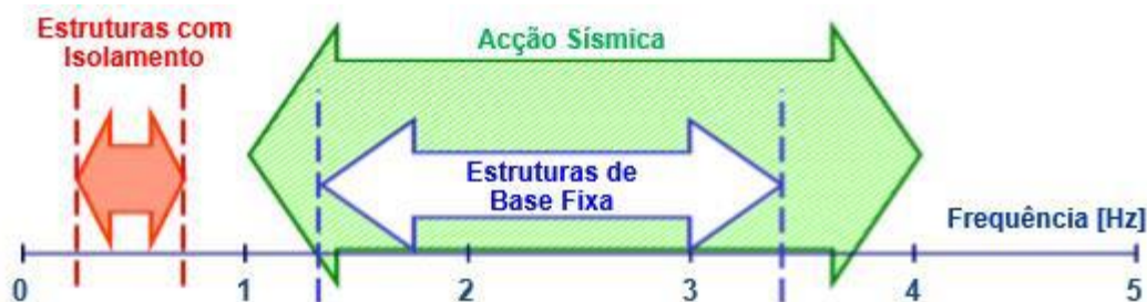
Figura 7 - Intervalo de Frequências para a Ação Sísmica e frequências próprias associadas a estruturas com e sem Isolamento de Base [24]
