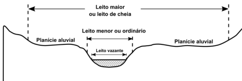
Figura 2. Perfil transversal de um curso de água. Esquema adaptado de Christofolletti (1981) e de Marafuz (2011).
