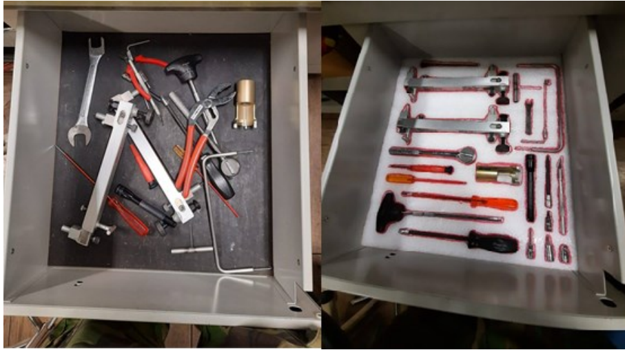
Figura 58 - Gaveta de ferramentas. Pré- lean : figura da esquerda e à direita resultado pós- lean .
