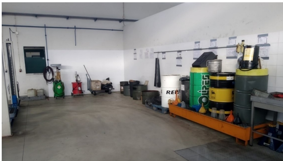
Figura 47 - Pós- lean - Zona de segregação de resíduos contaminados.
