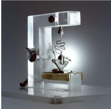
Figura 2 - Primeiro Transistor, Nokia Bell Labs [2].
