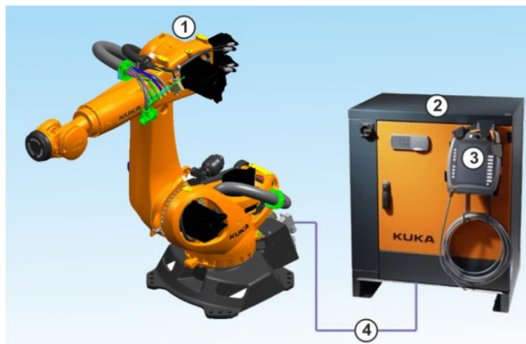
Figura 23 - 1 Robô, 2 controlador, 3 teach pendant(consola) e 4 ligações.
