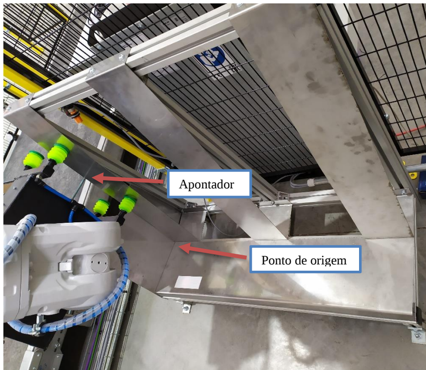
Figura 80 – Apontador numa posição aproximada do ponto de origem da base de trabalho.
