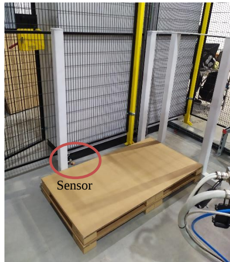
Figura 47 - Representação do sensor de presença de paletes no armazém.
