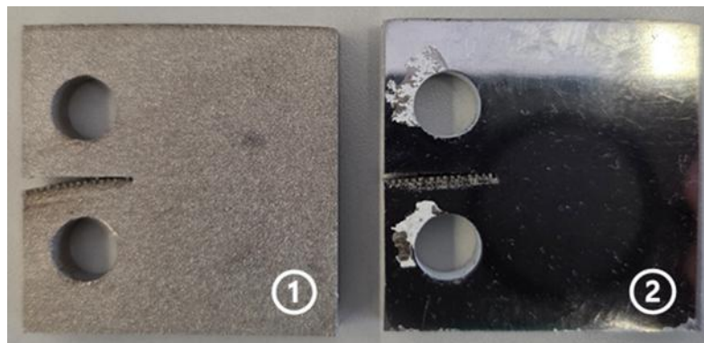
Figura 3.3 - Face do provete C(T) sem polimento (1) e polida (2).
