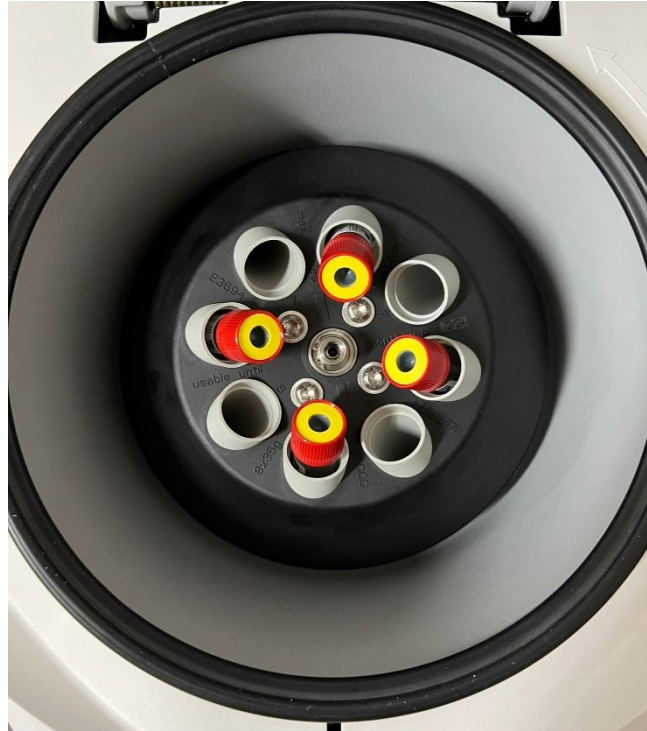
Figura 22 - Vista superior do rotor da centrífugadora "INTRA-SPIN". Figura do autor.
