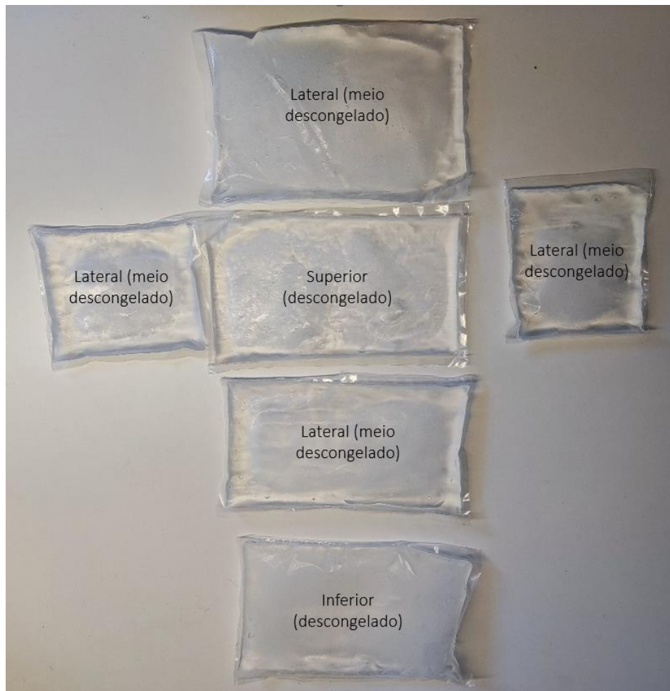
Figura 34 - Estado do gelo a meio de um teste
