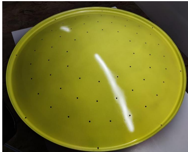
Figura 81 - Parabólica já pintada e furada pronta a levar as células
