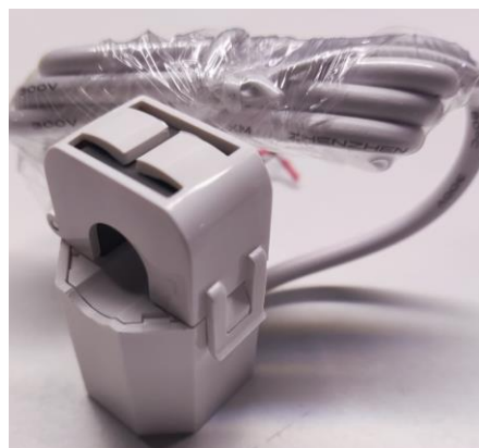
Figura 47 - Pinças amperimétricas de 50A
