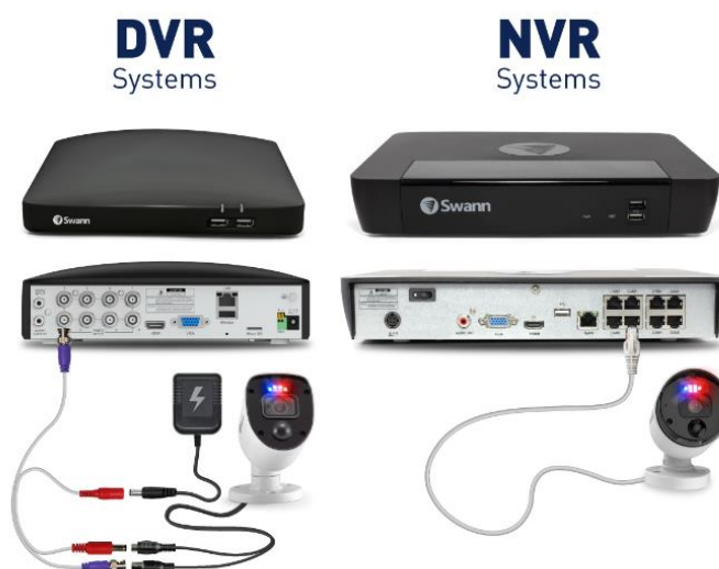
Figura 2 - Sistema DVR vs NVR
