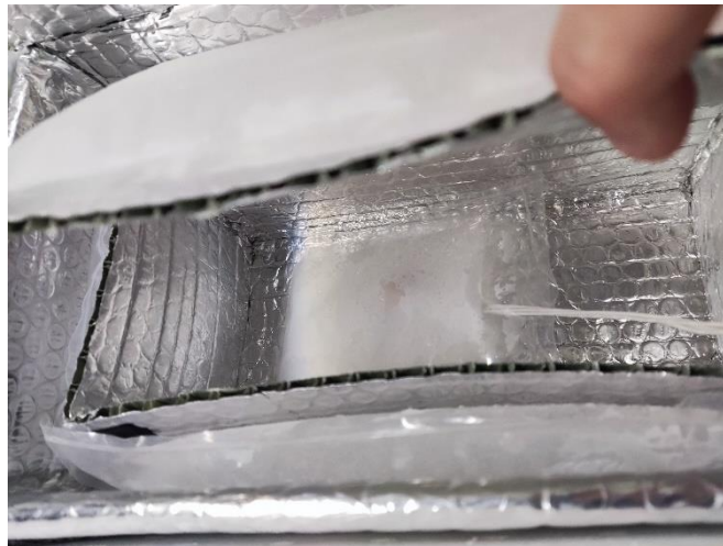
Figura 29 - Fibras absorventes (simular carne – 75g)
