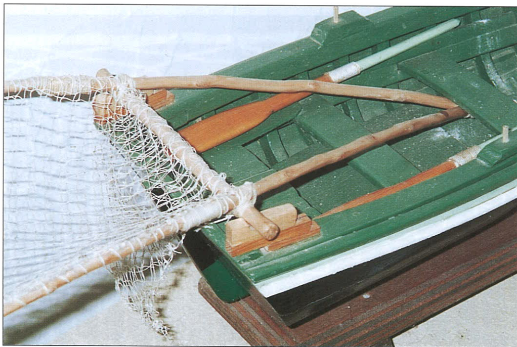
Fotografia 10 - Miniatura de embarcação de pesca, pormenor da popa (sistema de alavanca da colher) - Museu do Rio - Guerreiros do Rio.
