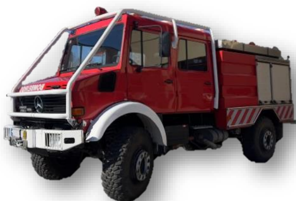
Figura 13 Veículo pesado florestal combate incêndios florestais
