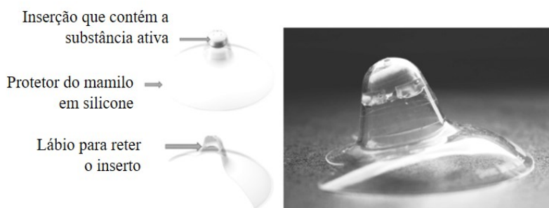
Figura 12. Ilustração esquemática do dispositivo “nipple shield” (esquerda) e imagem do protótipo, incluindo a inserção para administração do fármaco (direita). Imagem adaptado de Lopez et al. (2015).
