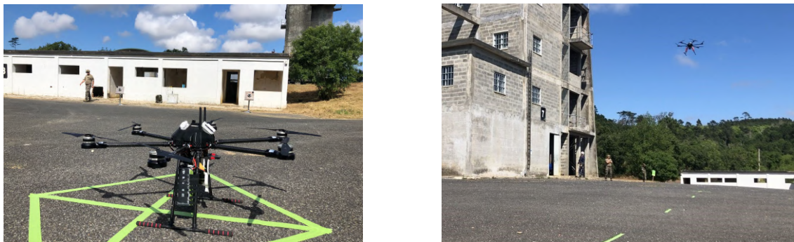
FIGURA 4.5: UAV Tarot X6 Hexacopter utilizado no primeiro dataset .
