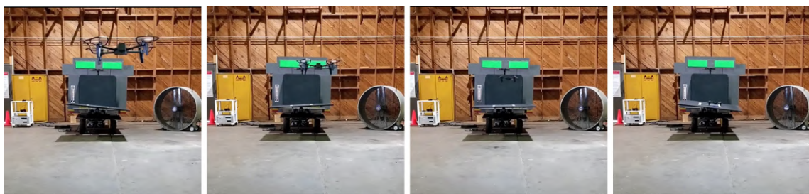
FIGURA 2.20: Dataset real de aterragem de UAV numa plataforma de simulação do balanço do navio (Saj, B. Lee, Kalathil e Benedict 2022).
