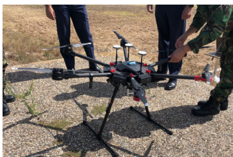
FIGURA 4.7: UAV DJI Matrice 600 Pro utilizado no terceiro dataset .
