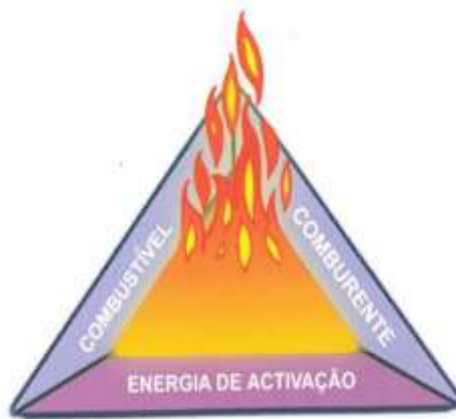
Figura 30: “Triângulo do Fogo” representando os 3 elementos necessários para se dar uma combustão
