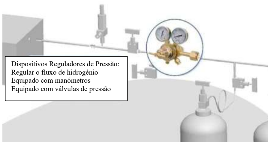
Figura 40: Representação de uma válvula de segurança reguladora de pressão
