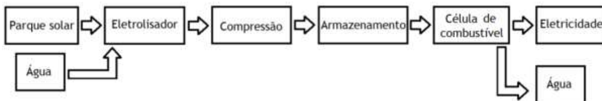
Figura 22: Processo de produção de hidrogénio verde por eletrólise, armazenamento e reconversão em energia elétrica libertando água
