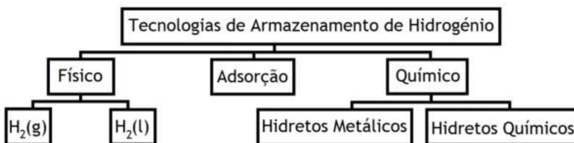
Figura 26: Esquema simplificado das tecnologias de armazenamento de hidrogénio
