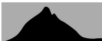
Fig. 7 - histograma de uma imagem exposta corretamente
