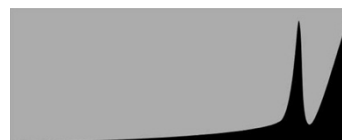
Fig. 9 – histograma de uma imagem sobreexposta
