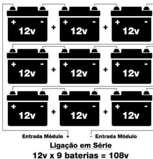
Figura 5.12 – Ligação de baterias em série (Infopasa, 2013)
