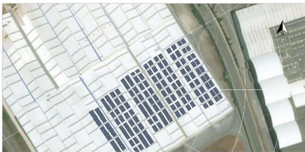
Figura 6.34 – Representação gráfica dos módulos monocristalinos
