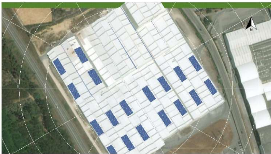
Figura 6.29 – Representação gráfica dos módulos voltados a Nascente-Poente
