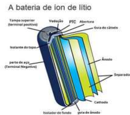
Figura 5.10 – Constituição bateria de lítio (BBaterias, 2012)
