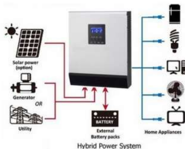
Figura 5.6 – Esquema inversor híbrido (MLB, 2018)
