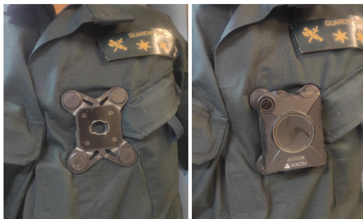
Figura n.º 1 - Fixação do Tipo Magnética da Câmara Portátil de Uso Individual na Guardia Civil
