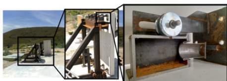
Figura 3: Representação de um corte de secção do Dispositivo de Absorção de Energia (DAE), inserido no sistema de proteção [18].
