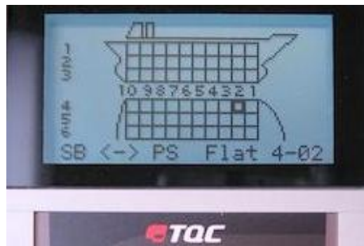
Fig.111. Monitor "LCD" do aparelho medidor/registador de rugosidade, podendo-se observar as diversas células e correspondentes coordenadas, associadas ao casco do navio, permitindo alternar a vista respectivamente para "estibordo" e "bombordo".
