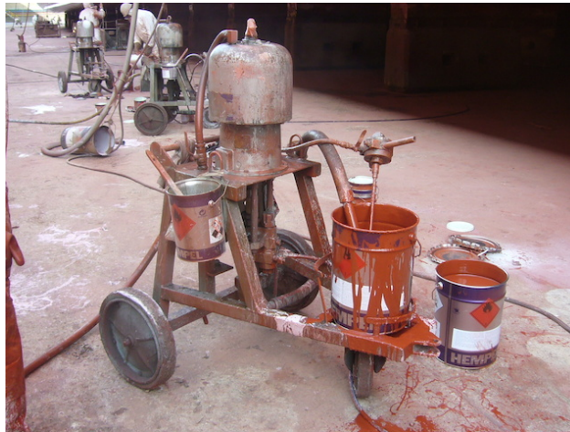
Fig.29. Sistema de Pintura "Airless" da marca "Graco", podendo-se observar a mangueira para alimentação externa de ar comprimido, a estrutura ou bastidor onde é colocada a lata de tinta e o agitador igualmente accionado por ar sob pressão.
