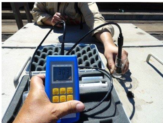
Fig.118. Dispositivo de medição de condutividade eléctrica, condutivímetro. Observa-se a respectiva sonda medindo a solução no copo graduado. Fonte: Foto do autor.
