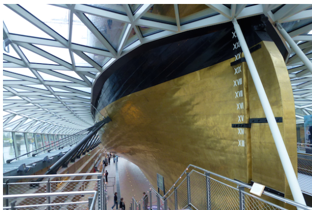
Fig.11. "Cutty Sark", ex Barca portuguesa "Ferreira", ex "Maria do Amparo" da CNN, Companhia Nacional de Navegação. Museu de Greenwich, Uk. Revestimento da querena efectuado por meio de placas em liga de cobre.
