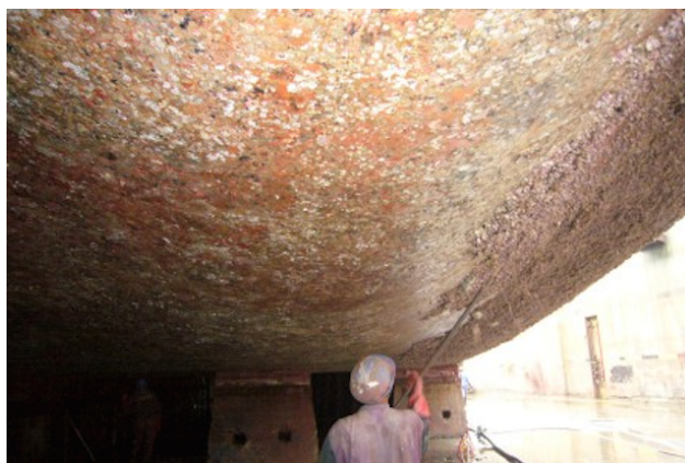
Fig.47. Raspagem manual de marisco e tintas soltas na região do encolamento e robalete. Fonte: Foto do autor.
