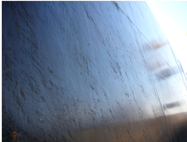
Fig.35. Verificação de vestígios de depósitos, aparentemente óleos, na superfície do costado durante operações de lavagem com água doce a alta pressão, o que terá obrigado, por motivo de dúvida, à presença do inspector que transportaria pequenas amostras de diluentes, por forma a caracterizar o estado da superfície e apresentar uma solução para o problema.
