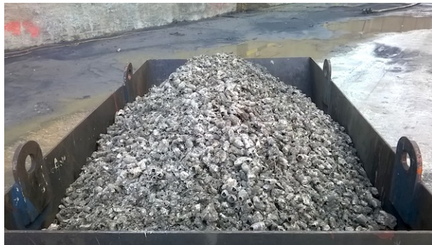
Fig.50. Recolha de marisco em contentor no fundo da doca, proveniente da operação de raspagem manual do fundo chato de um navio. Cracas de base circular com diâmetro médio de 30 mm. Fonte: Foto do autor.
