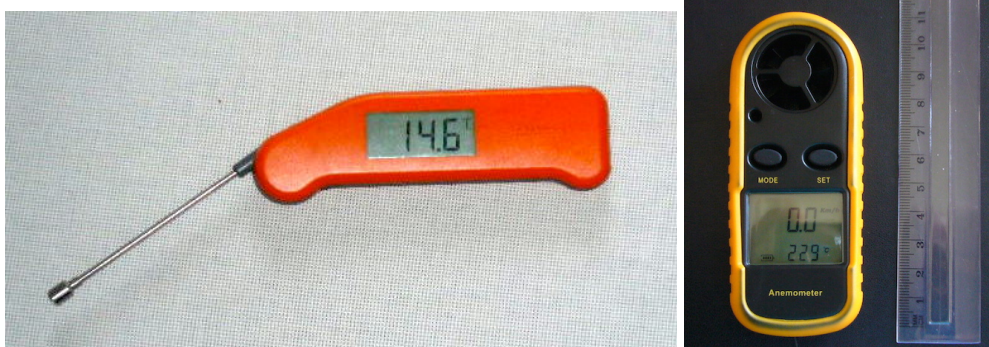
Fig.96. Instrumentação: Termómetro de contacto de superfície e anemómetro portátil. Fonte: Fotos do autor.
