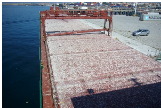
Fig.16. Escotilhas e convés de um navio no Porto de Leixões, sujeito a longo período de imobilização. Séria contaminação por dejectos de gaivotas, obrigando futuramente a uma cuidada e extensa preparação de superfície previamente às operações de pintura.
