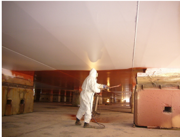
Fig.28. Aplicação de “A/A” de silicone no fundo chato, sobre uma demão "tye-coat" (Nexus) igualmente de silicone, conforme se pode observar, em cores totalmente contrastantes.
