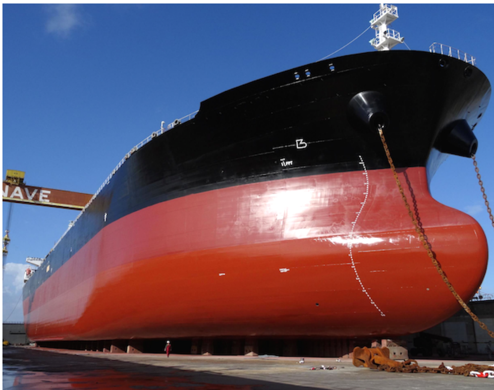
Fig.106. Conclusão dos trabalhos de aplicação de Silicone no fundo chato e fundo vertical de um navio tanque docado na Lisnave. "Boottop" revestido por "A/F" autopolimentante e "Topside" com acabamento em poliuretano. Fonte: Foto do autor.
