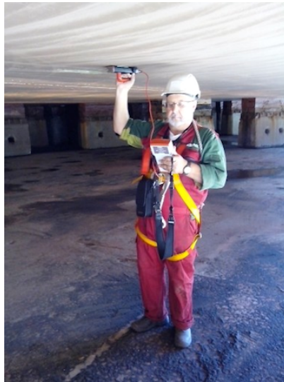
Fig.46. Medição de rugosidade no fundo chato. Primeira fase, após "LAP". Fonte: Foto do autor.
