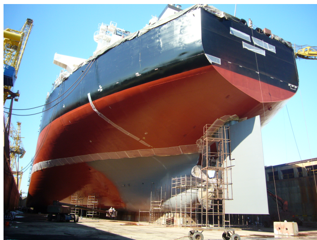
Fig.75. Docagem na Lisnave Mitrena. Fase de aplicação de “A/A” Hempasil/Silicone no fundo vertical. Pode observar-se a colocação de "máscaras" ao longo da "LLL" e também nos calados no "Boottop" já pintado com “A/V” autopolimentante, e nos nomes no "Topside", evitando assim comprometer a aderência das marcações por eventual "contaminação" por silicone pulverizado nessas áreas.
