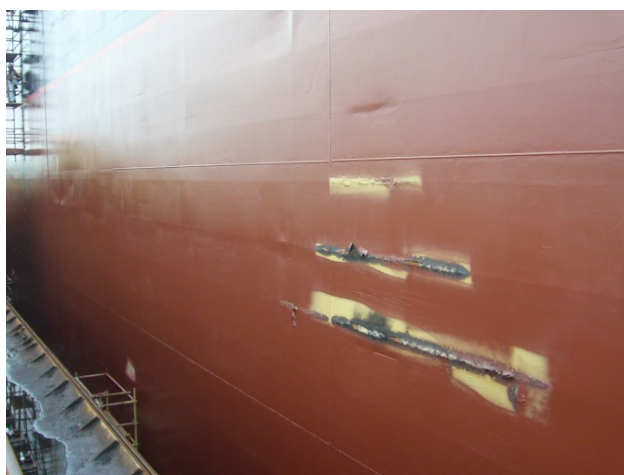
Fig.81. Após a conclusão da fase principal de pintura, ocorrem por vezes trabalhos no interior e exterior do casco, nomeadamente queimados devido a soldaduras que provocam o dano das películas de tinta nova aplicada. Fonte: Foto do autor.
