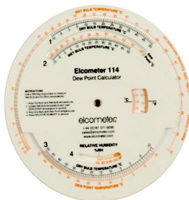
Fig.94. Disco calculador do ponto de orvalho. Entrando com a temperatura do bolbo seco e a humidade relativa obtem-se a temperatura do "P.O." Fonte: https://ptmusindo.files.wordpress.com/2012/06/114-dewpoint-calc.jpg
