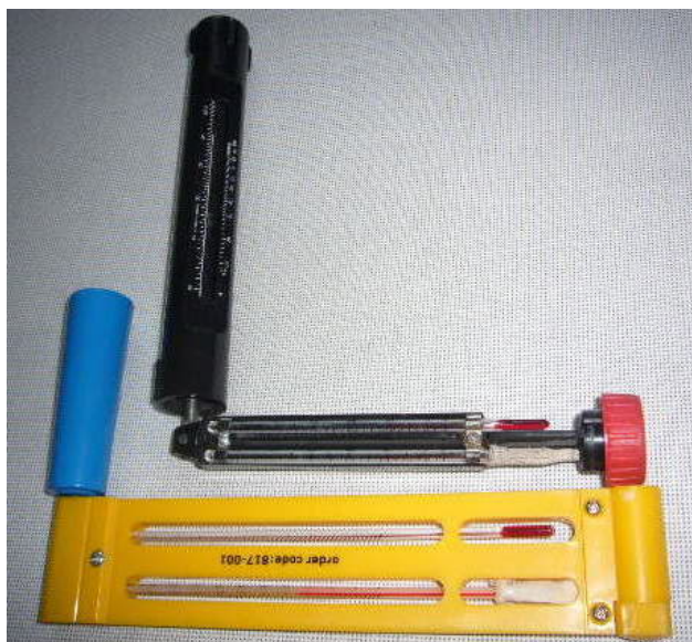
Fig.95. Modelos distintos de psicrômetros utilizados em campo. Em ambos os aparelhos, observa-se o bolbo húmido envolvido pela manga textil. Fonte: Foto do autor.
