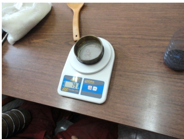
Fig.122. Pesagem de granalha. Retenção de material no filtro de malha 1,20mm. Fonte: Foto do autor.
