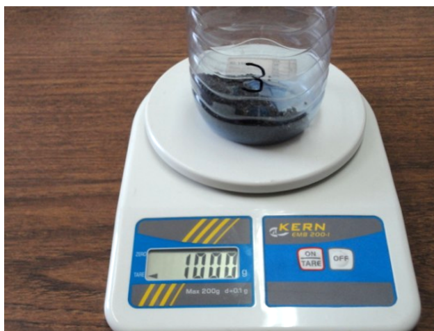
Fig.124. Pesagem de um lote 100g de granalha para testes de condutividade. Fonte: Foto do autor.
