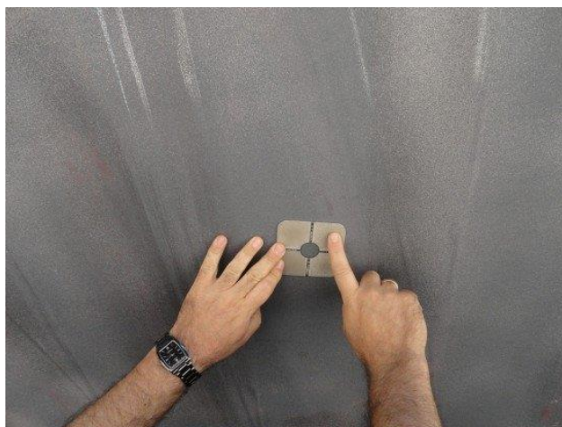
Fig.62. Verificação do padrão de rugosidade da superfície do fundo vertical, recentemente decapada, por meio de um rugosímetro-comparador táctil, para avaliar o adequado perfil de ancoragem para aplicação de tinta.
