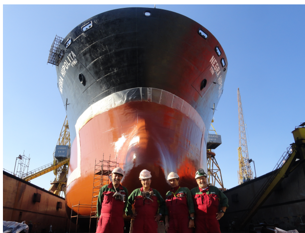
Fig.114. Docagem de um navio na Lisnave Mitrena em 2014. Equipa "Hempel" após aplicação de Silicone no Fundo Chato e Fundo Vertical. Esta actividade, e consoante as dimensões e especificidades do navio, requer nesta fase, uma equipa composta por vários elementos para supervisão das operações. Fonte: Foto do autor.
