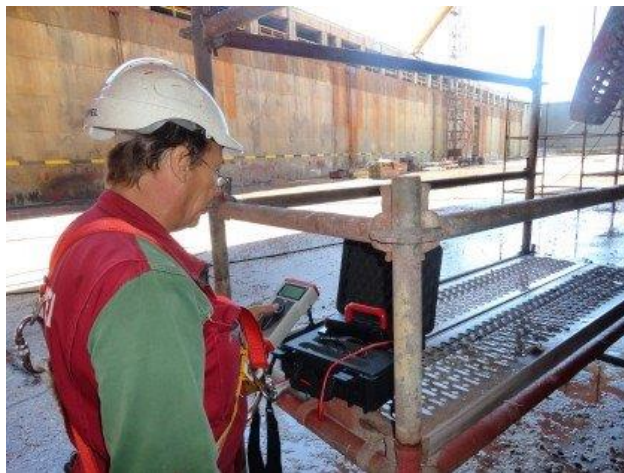
Fig.45. Calibração do aparelho medidor de rugosidade. Fonte: Foto do autor.
