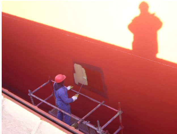
Fig.84. Retocando a rolo zonas entretanto danificadas por soldadura no fundo vertical após efectuar tratamento mecânico manual.
