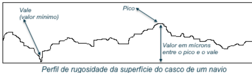
Fig.109. Perfil típico de rugosidade de uma superfície pintada, corte ampliado, revelando irregularidades de ordem micrométrica entre valores máximos e mínimos. Fonte: Desenho do autor.
