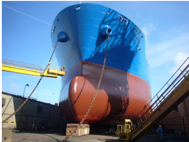
Fig.68. Braços articulados, "Dock arms", a "BB" e "EB", com deslocação sobre carris ao longo de toda a extensão do navio. Estes meios proporcionam pela sua flexibilidade, um acesso fácil e rápido a qualquer zona do casco.
