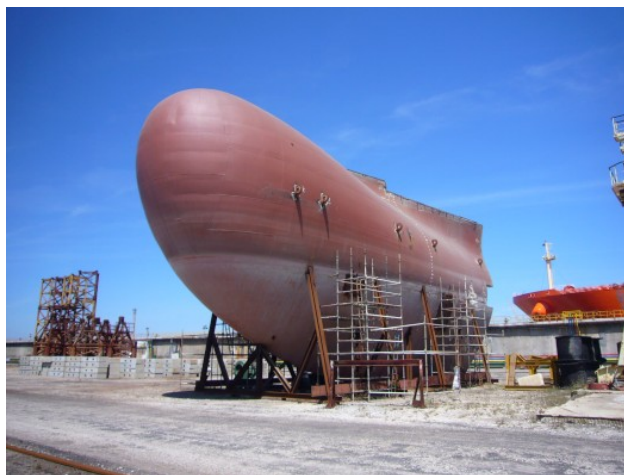
Fig.117. Lisnave Mitrena. Durante as docagens houve oportunidade de observar este bolbo original, objecto de substituição por outro novo e mais ajustado a novos padrões de velocidade mais reduzida.
