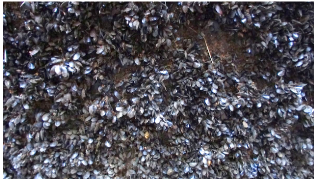
Fig.49. Revestimento extenso de marisco no fundo de um navio, provocando um elevado atrito do casco em condições de navegação. Fonte: Foto do autor.
