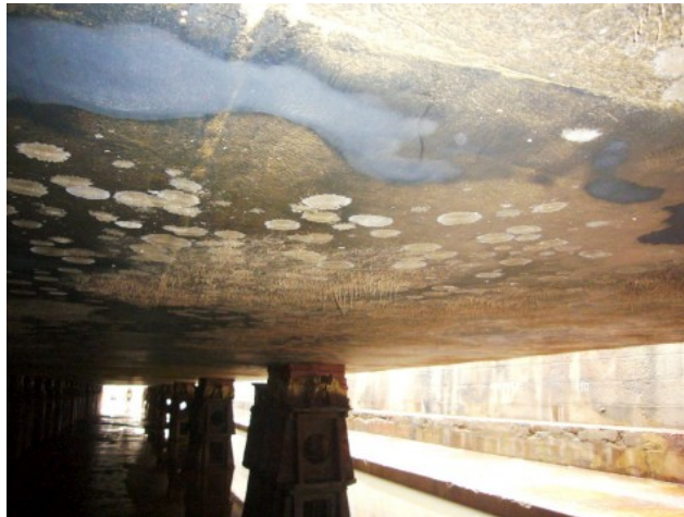
Fig.10. Fundo chato de navio após entrada em doca. Observam-se algumas colónias de organismos vegetais, na forma de algas pendentes designadas na gíria por "barbas".
