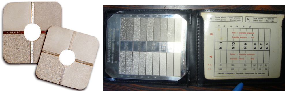
Fig.54. Rugosímetros-comparadores tácteis, destinados a interpretar o padrão da rugosidade superfície alcançado pela decapagem. Fonte: "Elcometer"; foto do autor.
