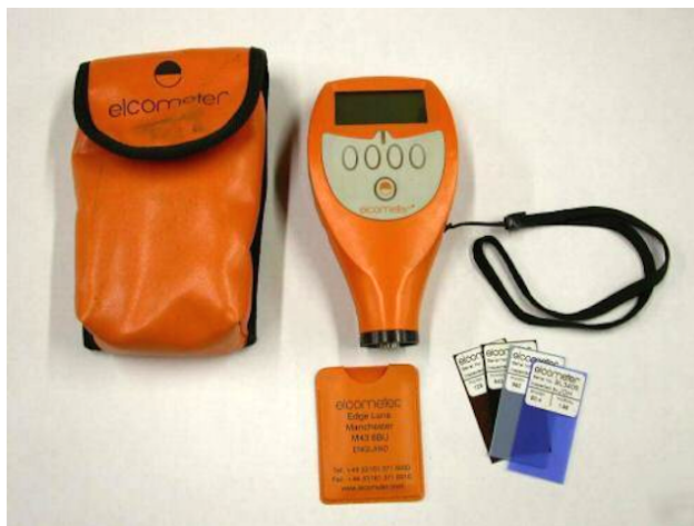
Fig.97. Instrumentação: Medidor/registador electrónico de espessura secas, com as respectivas películas de espessura definida para calibração do aparelho.
