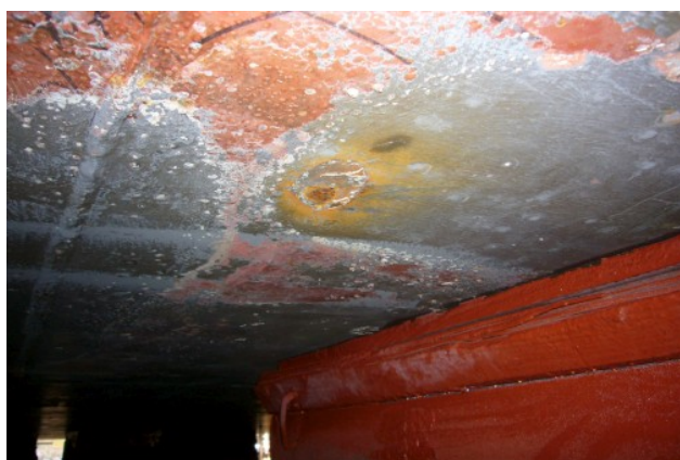
Fig.51. Aspecto do fundo chato após "LAP". Podem observar-se as zonas de picadeiros de docagens anteriores desprovidas de película de "A/V". Fonte: Foto do autor.
