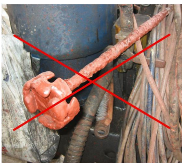
Fig.73. Agitador impróprio para utilização por mau estado de limpeza. Fonte: "Hempel".
