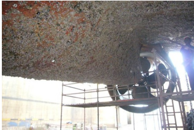
Fig.41. Raspagem de marisco no fundo chato de uma draga. Considerando a extensão de organismos encontrados em virtude dos períodos alargados de imobilização e baixa velocidade devido à especificidade de operações deste navio, optou-se neste caso concreto, por efectuar primeiramente a operação de raspagem, seguindo-se então a “LAP”.
