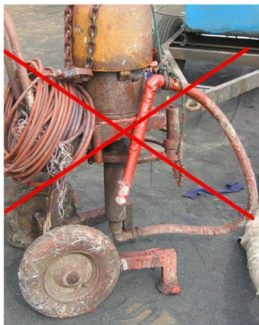
Fig.72. Tubo de aspiração de tinta em condições inaceitáveis. Fonte: "Hempel".
