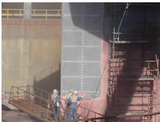
Fig.57. Decapagem manual ao grau sa 2 ½ da porta do leme, usando bailéu. Fonte: Foto do autor.
