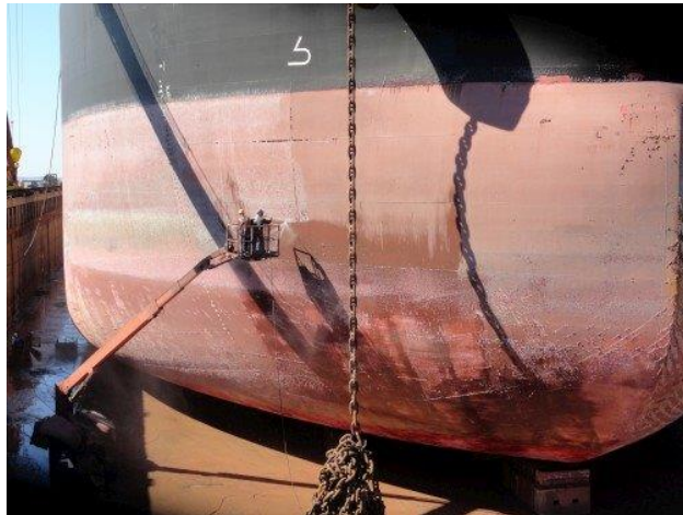
Fig.37. "LAP". Observa-se a remoção total de limo rasteiro e parcial de marisco, obrigando a posterior raspagem manual.
