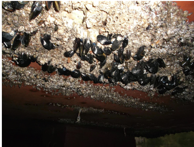
Fig.8. Colônias de marisco, bivalves e univalves, mexilhão e cracas, dispersas no fundo chato de um navio, revelando um razoável período de imobilização. Fonte: Foto do autor.
