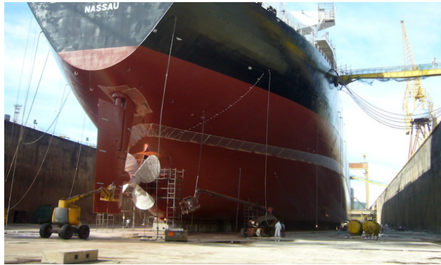
Fig.76. Operação de isolamento do hélice e dos zínco da porta do leme. Fonte: Foto do autor.
