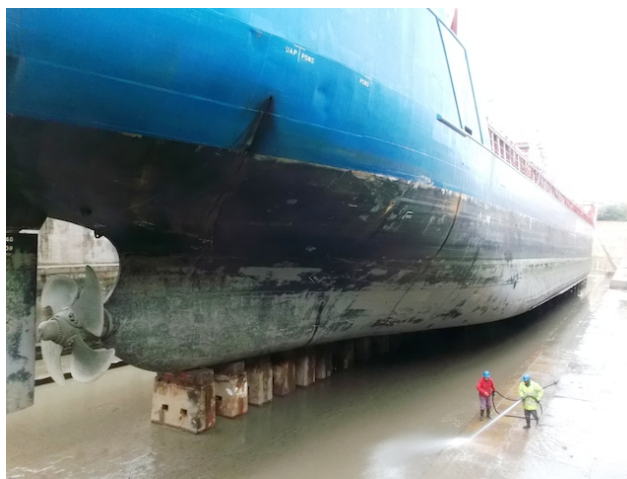
Fig.31. Assentamento do navio nos picadeiros. Lavagem do fundo da doca para remoção de lamas acumuladas. Observam-se facilmente os depósitos de organismos vegetais ao longo de toda a superfície do "boottop" do fundo vertical e no hélice, reflectindo de alguma forma um possível período de recente imobilização.
