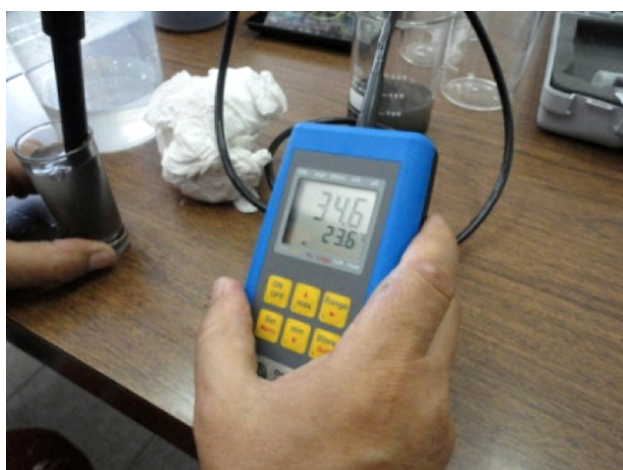
Fig.126. Medição da condutividade de sais da granalha em solução.
