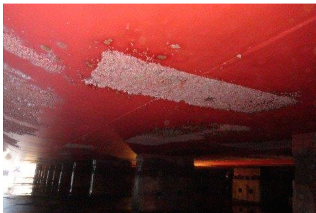
Fig.9. Colônia de cracas pequenas, "baby barnacles" implantadas em zonas ocupadas pelos picadeiros velhos na docagem anterior, sem tratamento anti-vegetativo. Fonte: Foto do autor.
