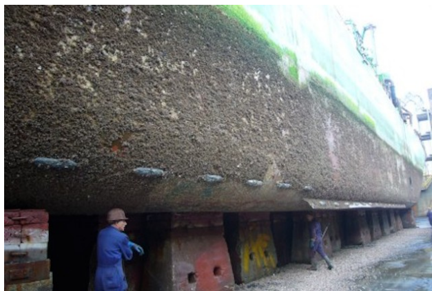
Fig.3. Grande densidade de inscrustrações. Este navio, de dragagens internacionais, em virtude das baixas velocidades de operação e períodos de relativa imobilização em águas quentes, proporcionou o desenvolvimento destas colónias biológicas mais acentuado, quando o período de vida útil do "A/V" foi excedido.
