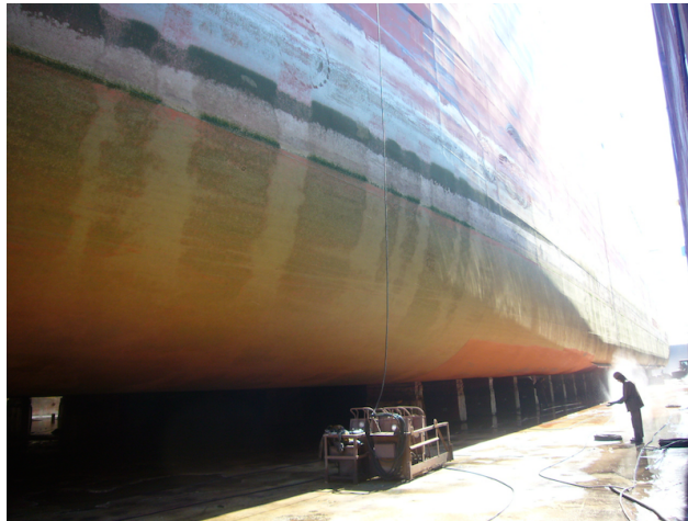
Fig.2. Docagem de um navio na Lisnave Mitrena em 2013. Condição do casco após esgoto da doca. Observa-se a presença de limo rasteiro extenso, mais acentuado numa faixa contínua com cerca de 40 cm ao longo de todo o perímetro.
