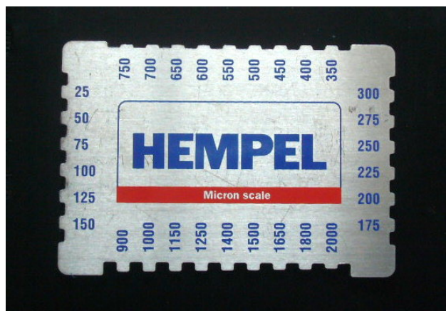
Fig.92."Pente". Dispositivo medidor de espessuras húmidas. Fonte: Foto do autor.
