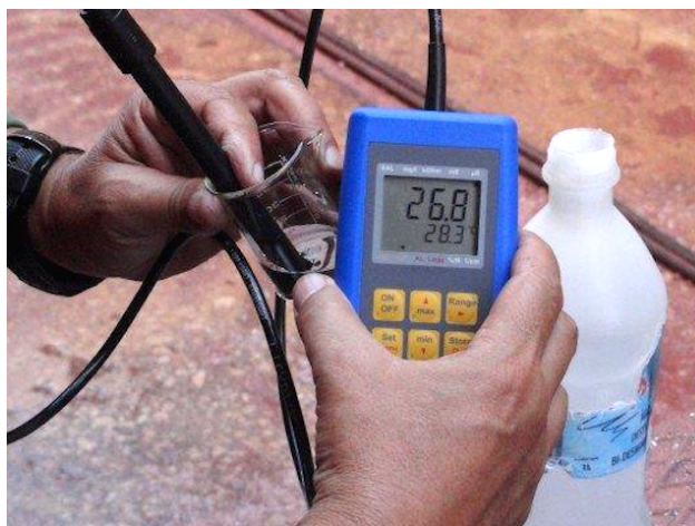
Fig.120. Medição da condutividade. Decorrido o período de tempo e actividade estabelecidas, a solução é extraída pelo mesmo método e colocada no copo graduado original onde se processa a medição, por meio da respectiva sonda, neste caso 26,8 \mu S/cm valor ao qual seria deduzido o “zero” padrão. Fonte: Foto do autor.
