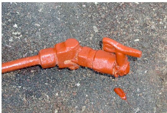
Fig.74. Aspecto do bico de pintura "airless" (nozzle) após aplicação de silicone. Fonte: Foto do autor.
