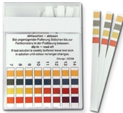
Fig.52. "Kit" de tiras de papel para medição de pH.
