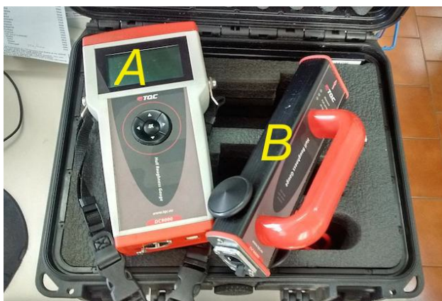
Fig.44. Aparelho medidor/registador de rugosidade da marca "TQC", composto pela unidade "A", memória/processador, e unidade "B", sonda/cursor-sensor. Propriedade da Hempel Portugal.
