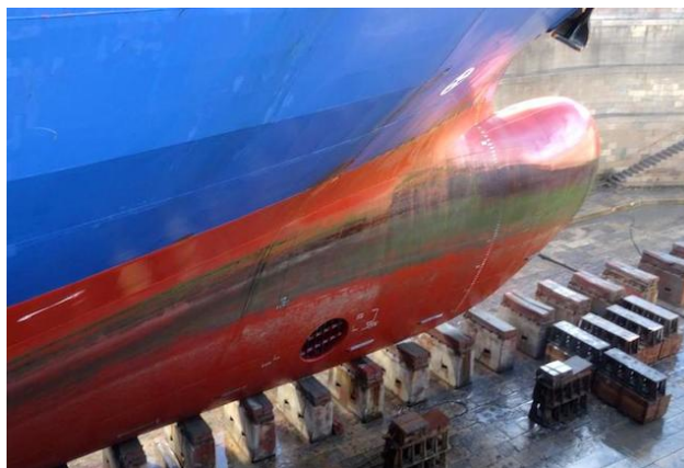
Fig.33. Entrada do navio em doca. Assentamento nos picadeiros da quilha.
