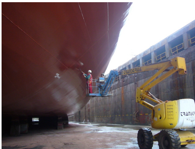
Fig.112. Medição da rugosidade após aplicação de "A/A" de silicone a BB, no fundo vertical, zona da proa do navio no encolamento.
