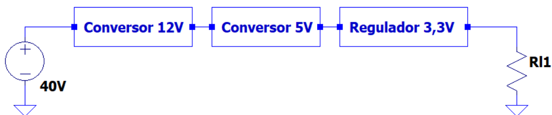
Figura 3.27 - Diagrama de blocos do teste ao rendimento do regulador de 3,3V em cascata.
