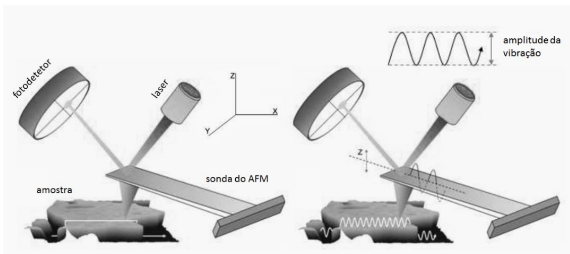
Figura 6. – Os modos básicos do MFA: modo de contacto (à esquerda) e o modo de contacto intermitente (à direita). (Adaptado de Oncins & Díaz-Marcos, 2012)
