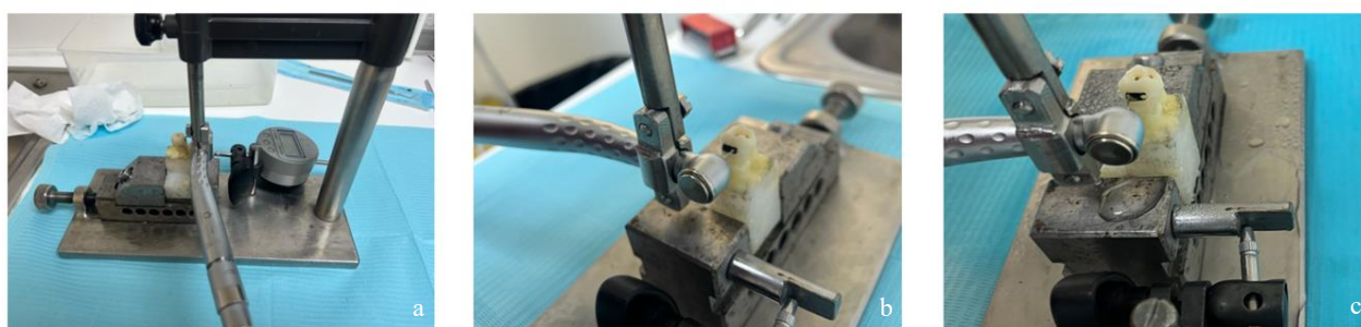
Figura 4 - Execução da cavidade de classe V com a máquina de padronização. a) Posicionamento do dente na máquina; b) Posicionamento do dente na máquina no primeiro ponto para fazer uma cavidade de 1,5 mm de profundidade; c) Posicionamento do dente na máquina no segundo ponto (Manso et al., 2011).
