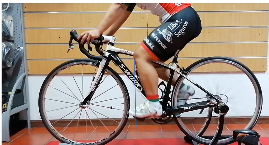
Figura 12. Método de Pruitt para a regulação da posição horizontal do selim.
