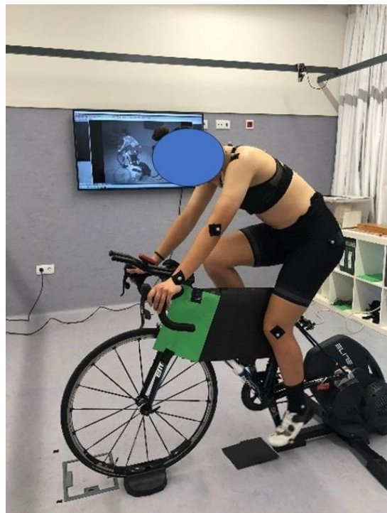
Figura 8. Avaliação biomecânica de uma ciclista utilizando um sistema de análise de movimento 3D, com marcadores de inércia detetados por um sistema de quatro câmaras óticas de grande definição.
