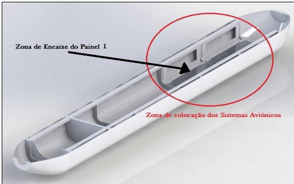
Figura 1 - Corte a meio do modelo da fuselagem do novo UAV da FAP. Legenda na zona de encaixe dos aviônicos (atrás do nariz) onde se pretende instalar o painel. (Imagem cedida pela FAP).
