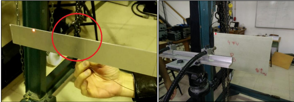
Figura 18 - Esq: Utilização do martelo numa placa teste; Dir: Placa suspensa com o laser apontado ao canto superior esquerdo.
