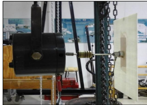
Figura 19 - Configuração de ensaio com shaker e acelerómetro.
