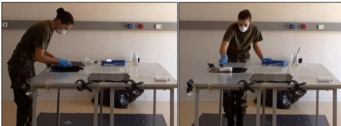
Anexo 2.3 - Esq : Colocação das fibras na posição e orientação correta; Dir : Aplicação da resina sobre as fibras;
