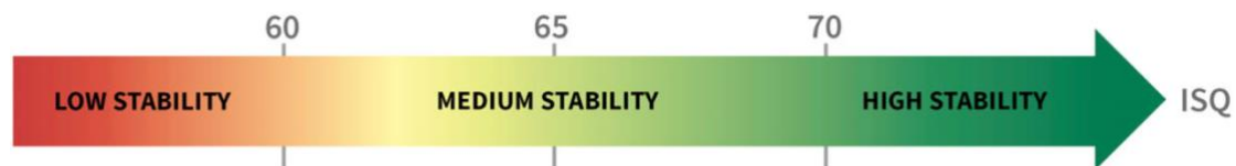
Figura 2. Ilustração dos valores de ISQ - Osstell, Gothenburg, Suécia. Valores > 70 indicam uma alta estabilidade, valores entre 60 e 69 indicam uma estabilidade média, e, valores < 60 indicam uma estabilidade baixa. Consoante o valor de ISQ, é avaliada a abordagem do tratamento restaurador: imediata (ISQ igual ou superior a 70) ou faseada. Imagem retirada de (Charatchaiwana et al., 2019).
