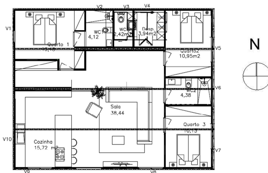
Figura 15 - Disposição dos contentores marítimos na habitação modular Fonte: Autora 2024
