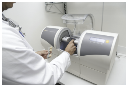
Figura 9 - CAM - As fresadoras Chairside têm um tamanho reduzido e são adequadas para uma variedade de tipos e materiais de restaurações (Blatz, 2019).
