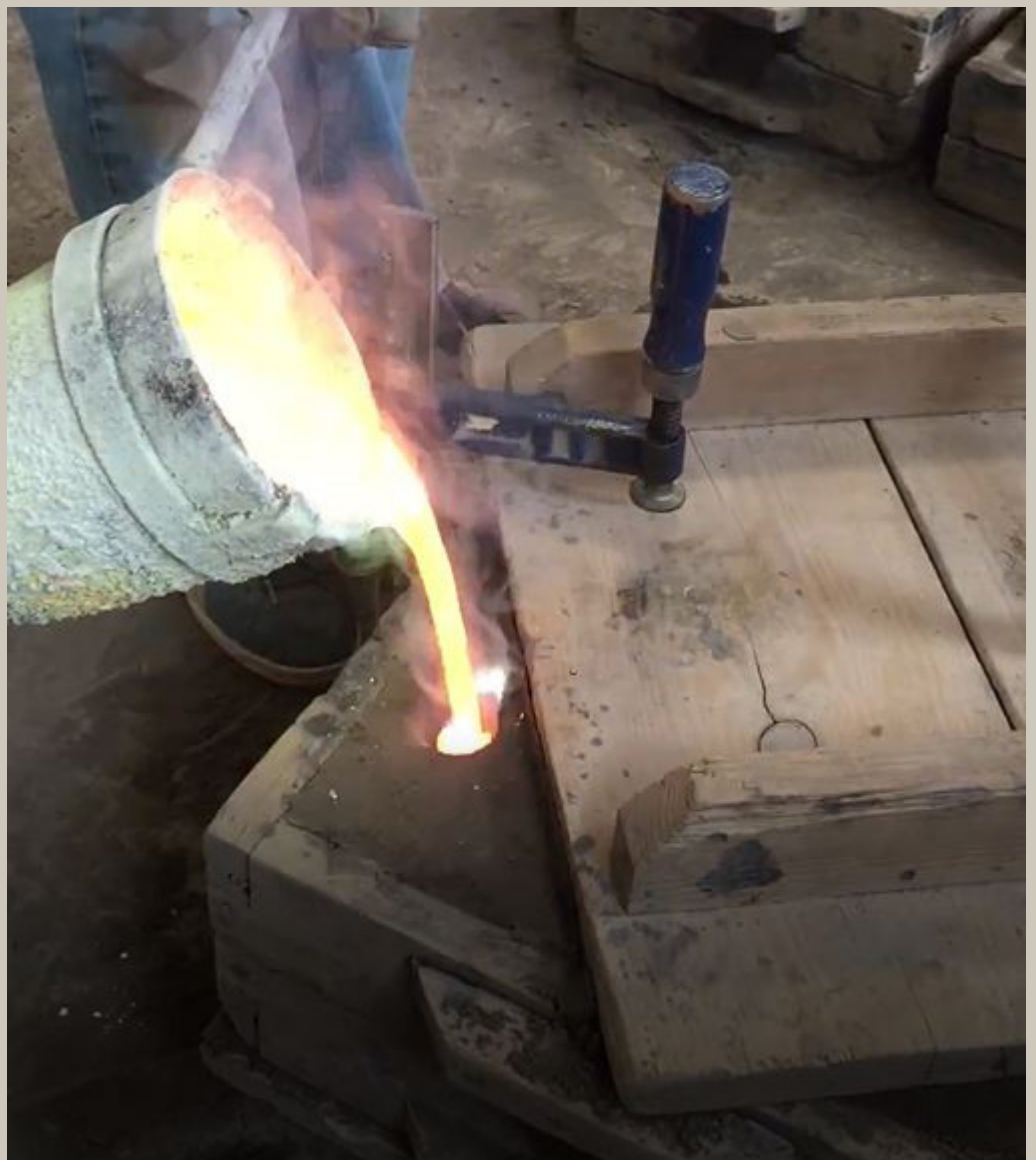
2.8. Pour the copper liquid into the template
