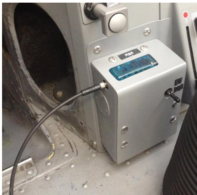
Figura 1 – Conexão do cabo USB ao equipamento MSR 165
