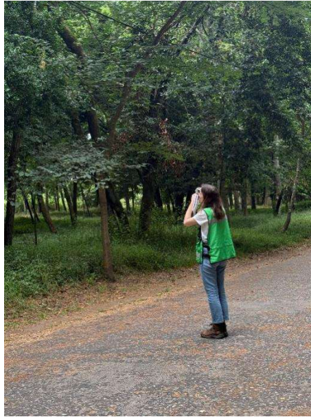
Figura 14- Medição da altura da árvore com utilização do Hipsómetro e Transponder.
