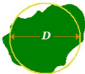
Figura 15: Diâmetro de Heywood: a área da projeção da partícula num plano (área de cor verde) é igual a área do círculo de cor amarela, e que tem o diâmetro D [4].
