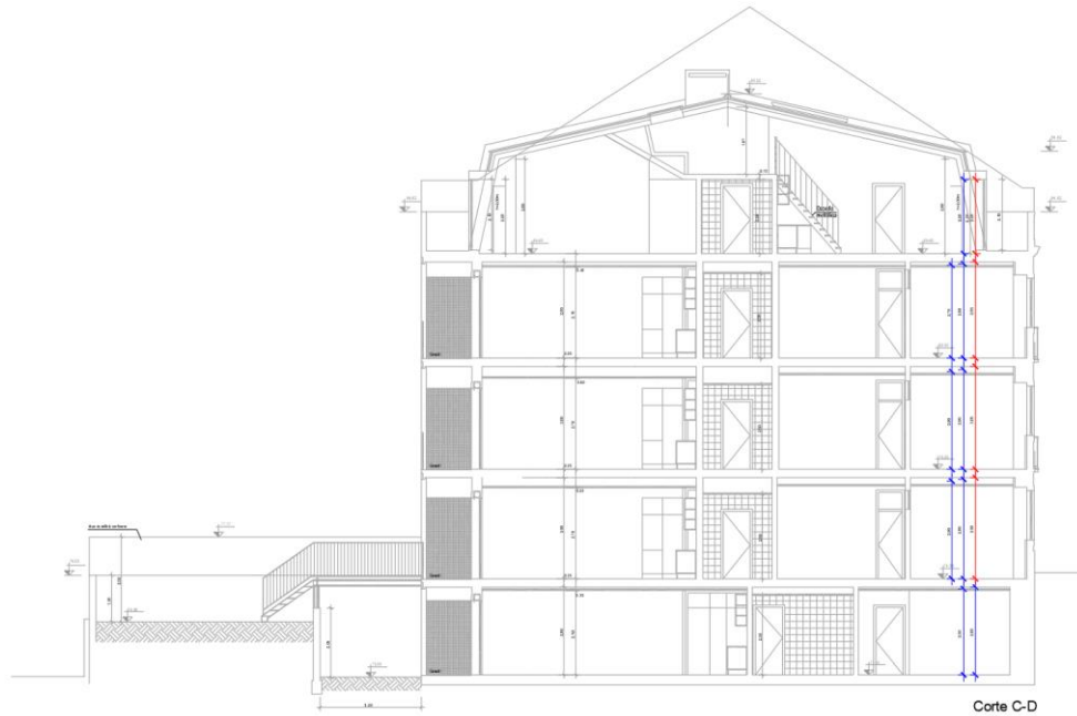
Figura 35 - Verificação da altura dos pés-direitos
