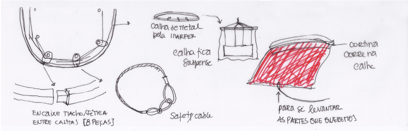
207| Esquissos do sistema de encaixe das divisões da calha e como é feita a suspensão da calha com o safety wire.
