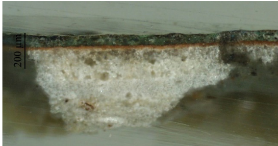
Figura 120. Corte estratigráfico da amostra 1.
