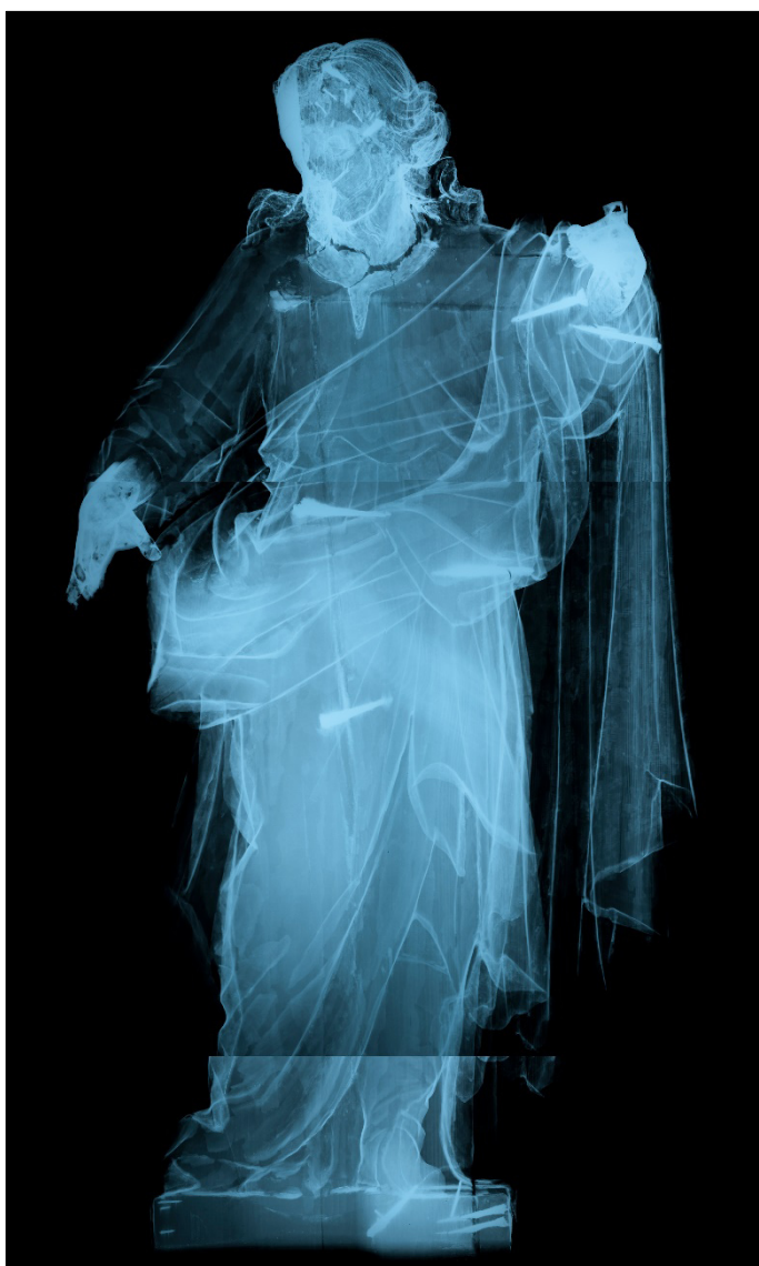
Figura 113. Montagem das películas obtidas na radiografia.
