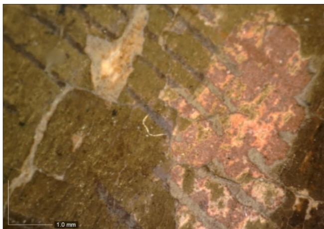
Figura 37. Pormenor de uma lacuna a nível da camada do bolo, onde é possível ver o seu tom avermelhado; observação ao microscópio digital com ampliação de 48 x. A. P.
