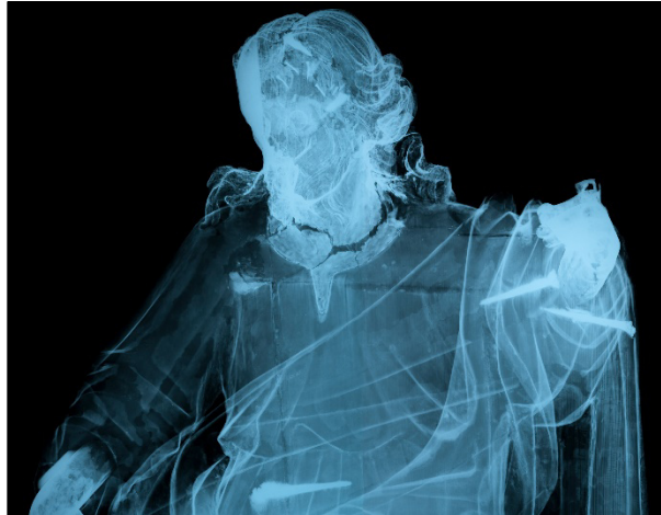
Figura 35. Pormenor da radiografia onde se observa a ligação dos blocos com elementos metálicos e a diferente opacidade na zona dos olhos.
