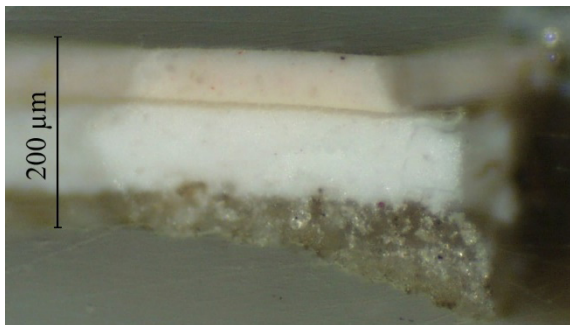
Figura 148. Corte estratigráfico da amostra 5.
