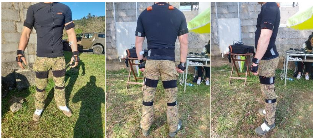
Figura n.º 6 - Xsens MVN com os 17 SI colocados nos respetivos segmentos do participante.
